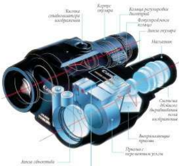
Устройство бинокля со стабилизацией изображения
